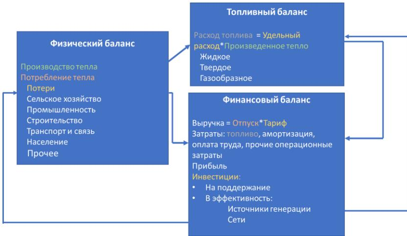
Рис. 1.14. Схема модели централизованного теплоснабжения
