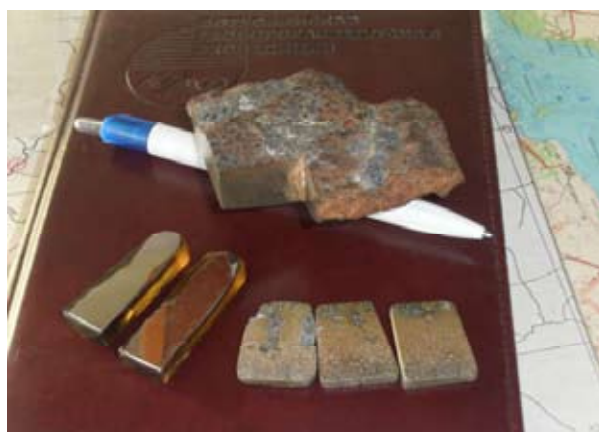
Рис. 3. Результаты электроплавки руды Томтора: слева – феррониобий, справа – редкоземельный шлак
