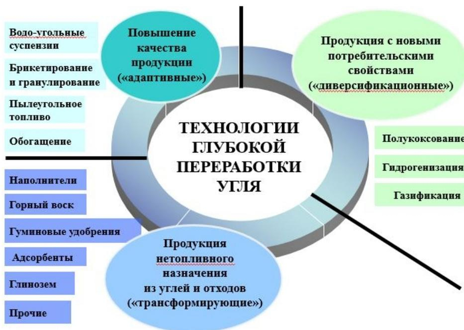
Рис. 7.8. Классификация технологий комплексной переработки углей
